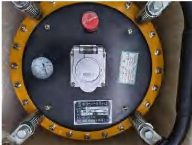
图 4-1 X 射线管头
