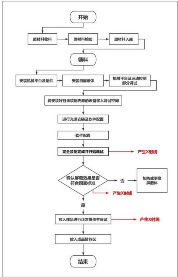
图 3.5 生产工业 CT 流程及产污环节
