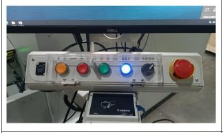
图 4-7 操作台停机按钮和控制锁
