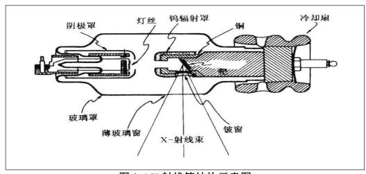
图 3-4 X 射线管结构示意图
