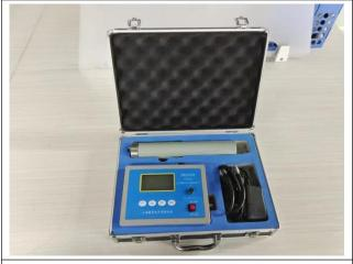
图 4-13 便携式 X-γ剂量率仪
