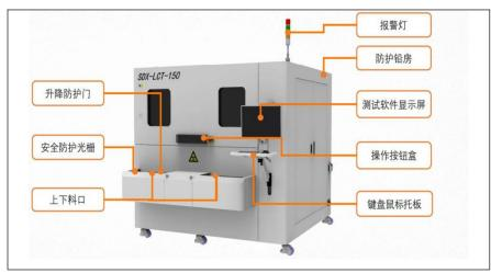
图 3-3 SDX-LCT-150 型机设备效果图
