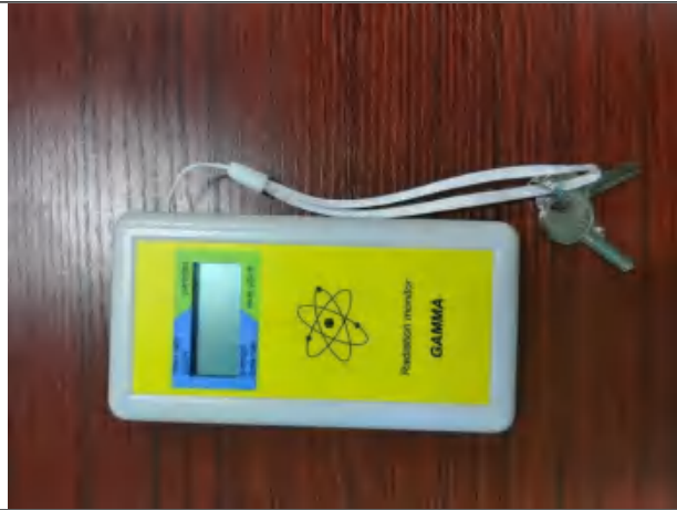
图 4-8 个人剂量报警仪
