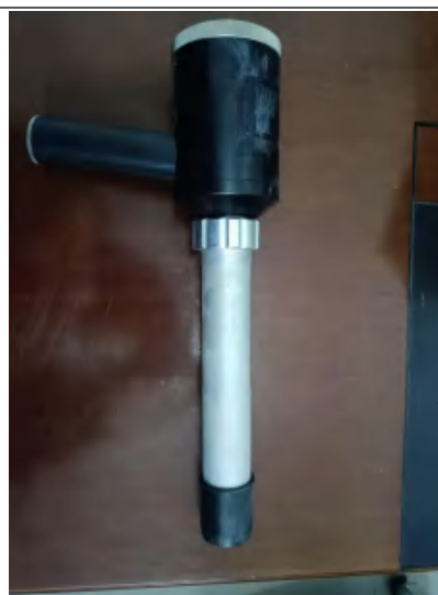
图 3-7 X-γ剂量率监测仪
