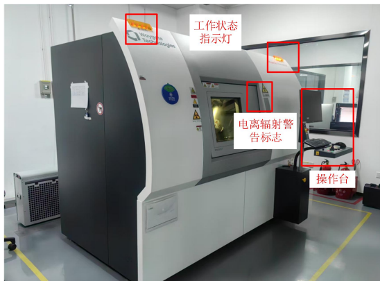
图 3-4 工作状态指示灯 电离辐射警告标志
