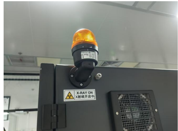
图 3-5 工业 CT 机后侧指示灯、上方通风
