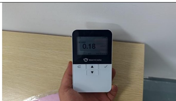
图 3-18 便携式 X、 \gamma 剂量率仪
