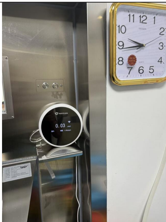
图 3-6 分装室固定式剂量率报警仪
