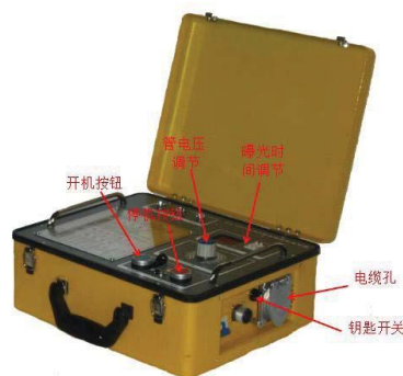
图2-8 X射线探伤装置控制器
